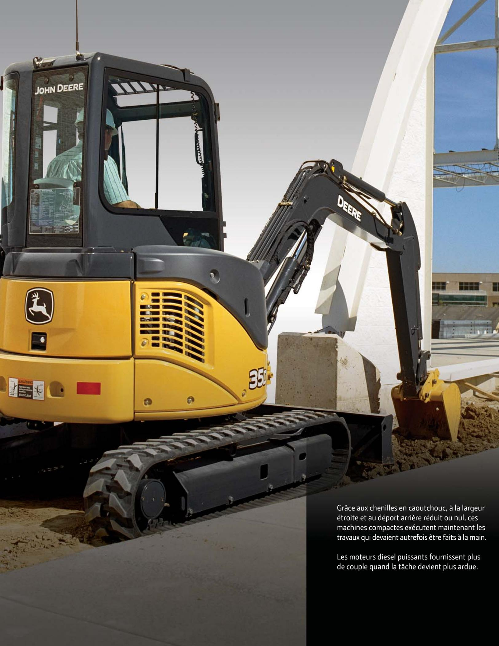
Grâce aux chenilles en caoutchouc, à la largeur étroite et au déport arrière réduit ou nul, ces machines compactes exécutent maintenant les travaux qui devaient autrefois être faits à la main.
